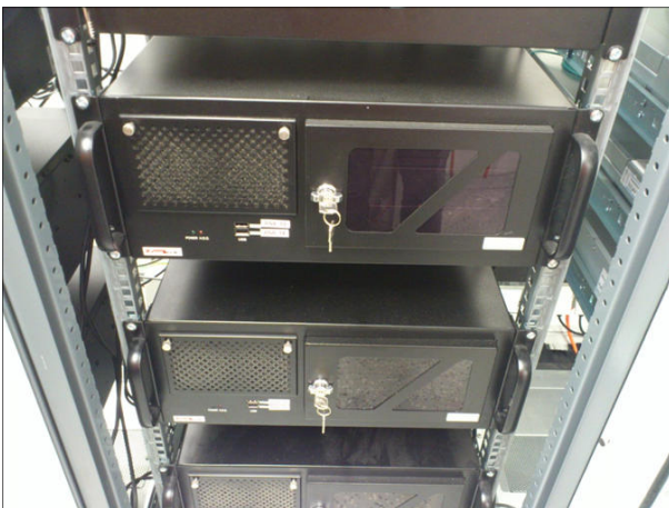
Detail na uložení počítačů do racku
